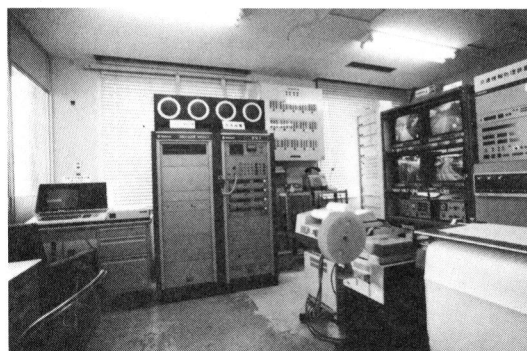
(左) 音声道路情報システム装置 (中) グライドメータなどの記録装置 (右) ITV、交通速度計
