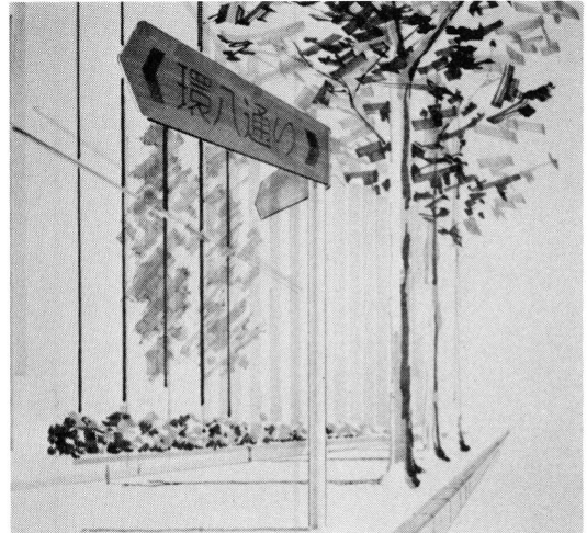
◀a) 比較的狭い道路に適用できる通り標識案 ▲b) 「く」字型通り標識 対向車線からも視認できる
