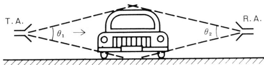
Fig. 5 垂直放射パターン Design of vertical radiation pattern
