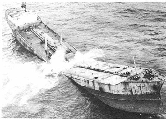
Fig. 2 法規上安全なはずのタンカーが荒天の海で折損する A tanker which is legally safe sometimes breaks down
