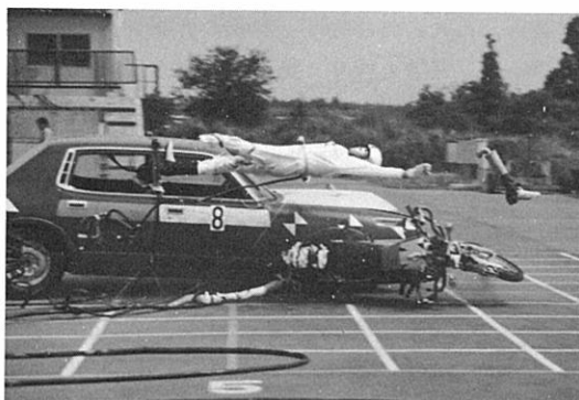
Fig.19 サイド衝突におけるダミー落下の例(側方へ落ちる例) 衝突速度 50km/h Falling pattern of dummy
